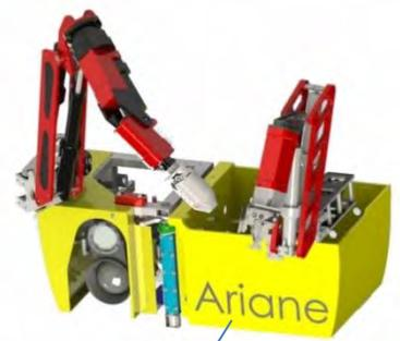
Le robot sous-marin est équipé d'un panier collecteur. Il permet de stocker les échantillons prélevés par les bras manipulateurs
